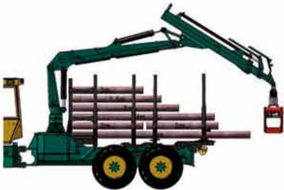
Zwillingsrunge schnellwechselbar für 2 x 2 oder 2 x 2,5 m Holz (nicht bei 805F Kurzversion)
