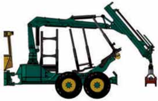
Seilrückung möglich ohne Umbau der Zwillingsrunge
