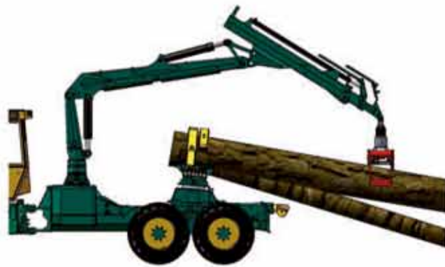
Langholzurückung mit schnellwechselnder Klemmbank
