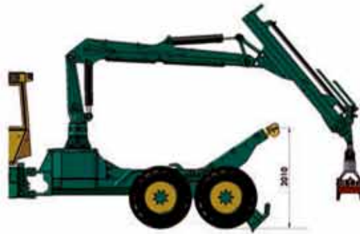
Höhenverstellbare Seilrollen auf bis zu 2 m
