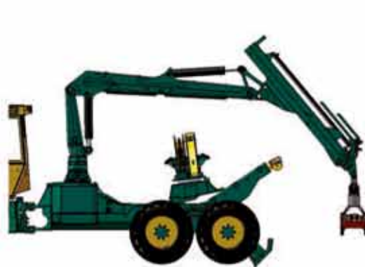
Seilrückung möglich ohne Umbau der Klemmbank
